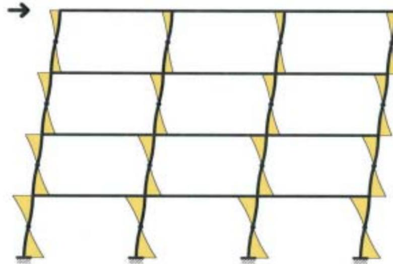
Esquema real con compartimentación en plantas superiores y planta baja diáfana
